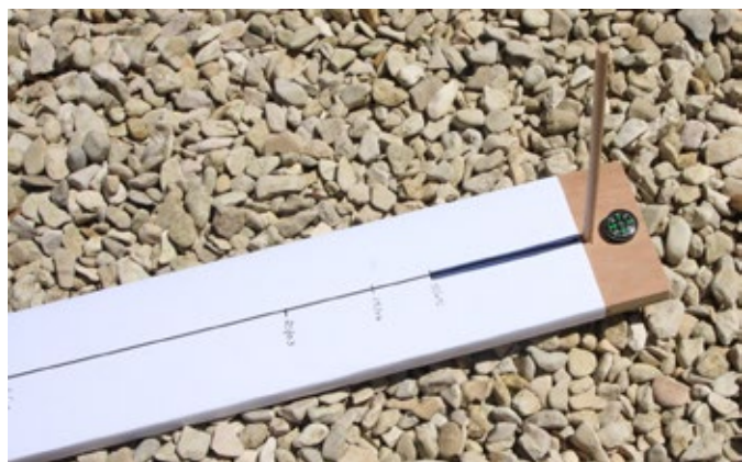
Fig.9. Méridienne horizontale constituée d'une planchette et d'un gnomon. Elle doit être orientée nord sud. On peut y noter la position de l'extrémité de l'ombre toutes les semaines ou tous les mois aux alentours du midi solaire (voir encadré), il suffit qu'il fasse beau. En réalité, il n'est pas nécessaire d'être très précis sur l'heure du midi solaire, la hauteur du Soleil varie peu au milieu de la journée.
