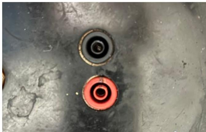
Fig.5. Le plastique des bornes électriques présentes sur le plateau d'origine a fondu à cause de décharges observées entre la base des fils électriques et le métal du plateau. Crédit A Durieux.
