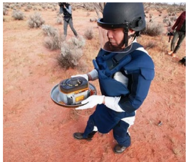
La capsule contenant les échantillons de Ryûgû. Le technicien est protégé en cas d'allumage intempestif d'un élément pyrotechnique destiné au déploiement du parachute.
