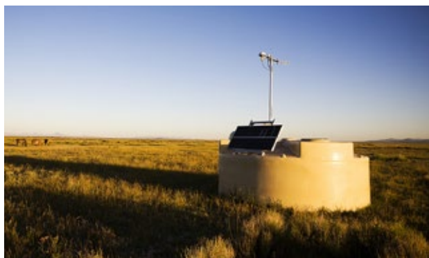
Fig.2a. Un détecteur de particules à effet Cherenkov (cuve à eau de 3,6 m de diamètre).
