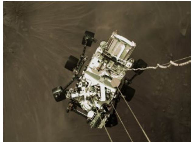
Image.3. Cette image exceptionnelle fait partie du film effectué par l'étage de descente de la mission Mars2020 le 18 février dernier. À 21 mètres au-dessus du sol à vitesse verticale descendante constante de 75 cm par seconde, le rover a été descendu au bout de trois câbles de 7,50 m de long, tout en déployant ses roues. Crédits : NASA/JPL-Caltech.
