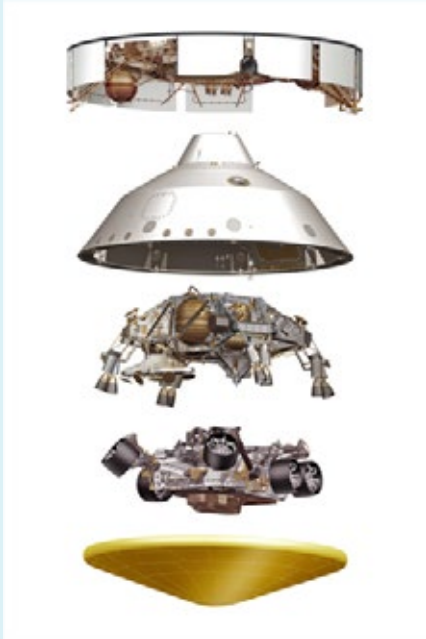
Image.2. Éclaté de la sonde, montrant les différents éléments qui ont joué un rôle pendant l'atterrissage du rover Perseverance, que l'on voit ici roues repliées.
