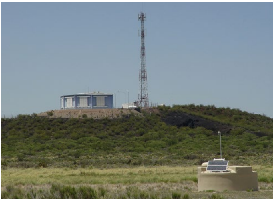
Fig.4. Au second plan l'un des bâtiments qui abritent six télescopes de fluorescence, surplombant au premier plan, un détecteur de particules.
