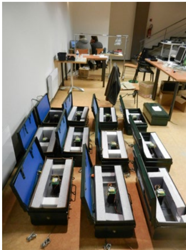
Fig.3. Fin du montage : les scintillateurs sont disposés dans des caisses. Ici, il s'agit des détecteurs utilisés dans l'expérience à la Auger comptant un réseau de 12 détecteurs.
