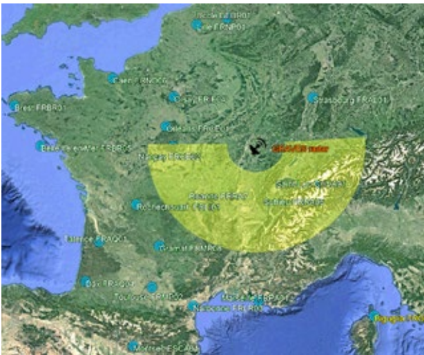
Fig.3. Répartition des récepteurs radio associés à certaines caméras FRIPON. En jaune : zone de couverture théorique optimale de détection radio des météores par le radar GRAVES.
