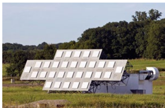
Fig.8. Une des 4 antennes d'émission du radar GRAVES utilisée par FRIPON.
