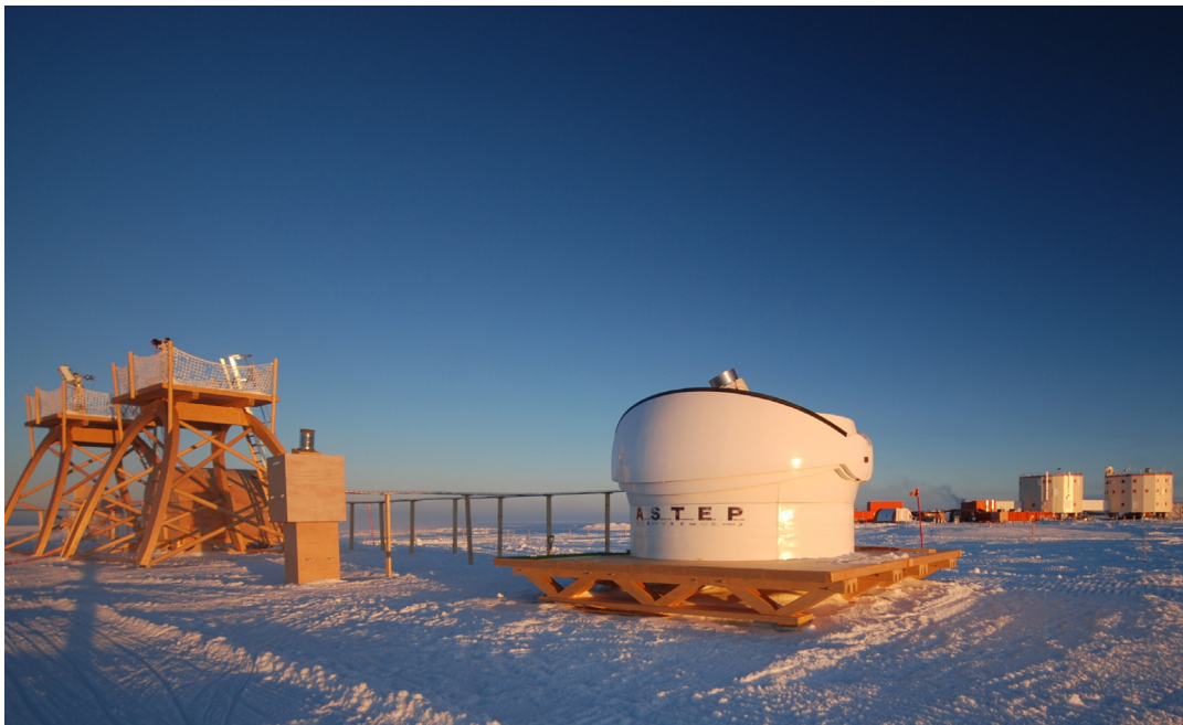
Fig.9. À côté de la plateforme Concordiastro, le télescope ASTEP – un télescope de Newton de 400 mm de diamètre avec un champ de vue de 1 degré carré. Largement automatisé, ASTEP est pointé en continu sur \beta Pic depuis mars 2017 afin d'y détecter un éventuel transit de l'exoplanète \beta Pic b (photo Djamel Mekarnia, OCA).
