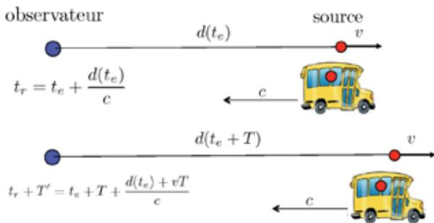
**Fig.5.** Principe de l'effet Doppler-Fizeau à partir d'une source en mouvement produisant un signal périodique se propageant jusqu'à l'observateur. L'intervalle entre deux émissions ( $T$ ) est différent de l'intervalle entre deux réceptions ( $T'$ ).
