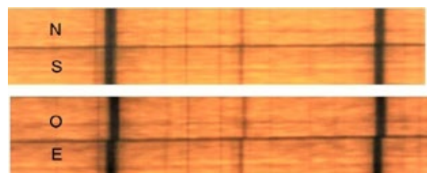
Fig.8. Images spectrales du doublet du sodium. Fibres positionnées sur les pôles Nord et Sud du Soleil (haut), et sur les limbes Ouest et Est à l'équateur du Soleil (bas).
