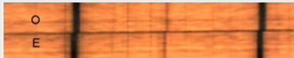
Fig.2. Images spectrales du doublet du sodium. En haut, le spectre obtenu en visant le point O est décalé vers le rouge alors qu'il est décalé vers le bleu pour le point E.
