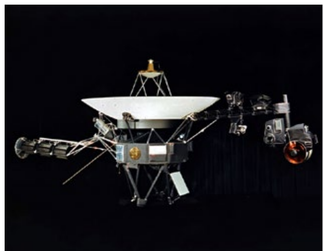
Fig.5. L'une des deux sondes spatiales Voyager identiques. La grande antenne mesure 3,70 mètres de diamètre.
