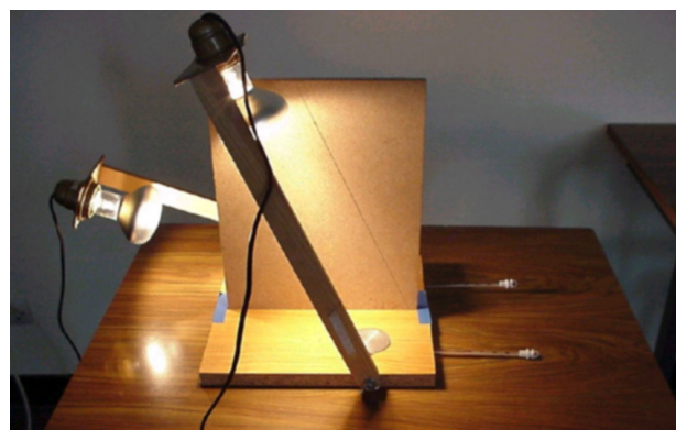
Fig.2. Le premier appareil présenté en 2001. La lampe au 1 er plan est inclinée à 66^\circ par rapport à l'horizontale et celle au 2 e plan à 20^\circ . Elles représentent le Soleil au solstice d'été puis d'hiver à midi. Elles chauffent un cylindre métallique dans lequel est inséré un thermomètre qui mesure l'élévation de température. La distance lampe-cylindre est de 30 \text{ cm} .
