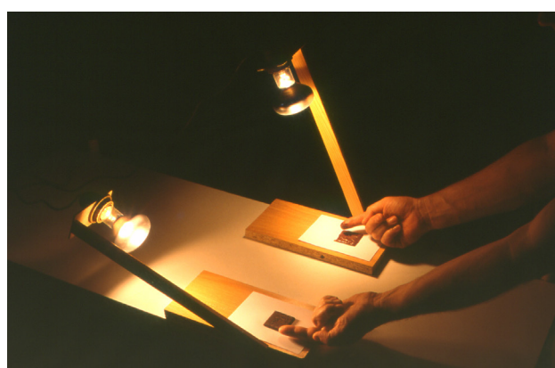
Fig.3. L'expérience du chocolat est très visuelle et marque les esprits. Le soleil d'hiver (ici au 1 er plan) chauffe moins que le soleil d'été, à cause de l'inclinaison de ses rayons. On peut vérifier que la distance lampe chocolat est la même sur les deux appareils.
