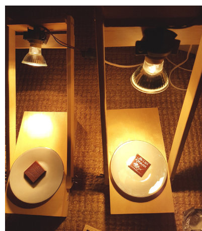
Fig.4. Deux morceaux de bois, une longue vis et un spot suffisent pour construire cet appareil. Avec une lampe de 50 W située à 15 cm du chocolat, il faut moins de 5 minutes pour voir fondre le «chocolat d'été». Attention à ne pas laisser allumé trop longtemps, il ne faut pas que le «chocolat d'hiver» fonde aussi. Le temps varie en fonction du type de lampe, de sa puissance, de la distance mais aussi de la marque de chocolat. Il faut construire deux appareils identiques pour comparer les résultats avec deux hauteurs de soleil.
