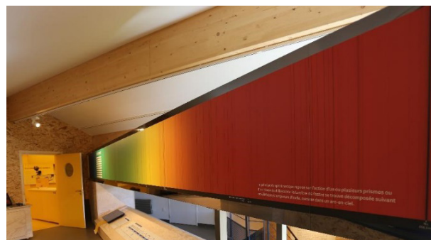
Fig.5. Vue du caisson qui enferme le spectrographe SHARMOR, et qui affiche sur un panneau latéral un spectre du Soleil de 8 m de long. La porte située en bas à gauche de l'image montre la taille de ce spectre.
