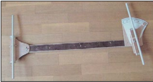
Parallaxomètre pour mesurer des parallaxes et comprendre ainsi les mesures de distances en astronomie (CC n° 121)
