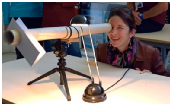
Fig.2. Observation virtuelle des satellites de Jupiter avec la pseudo-lunette de Galilée et son micromètre.
