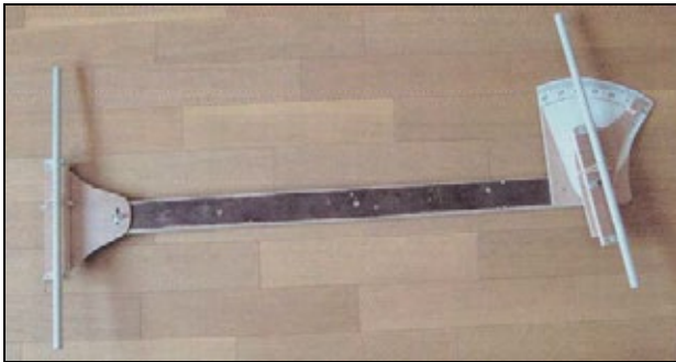
Parallaxomètre pour mesurer des parallaxes et comprendre ainsi les mesures de distances en astronomie (CC n° 121)
