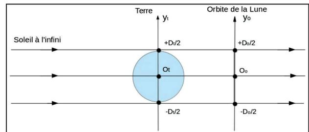
**Fig. 6.** Éclipse de Lune : principe de la méthode d'Aristarque. Si on suppose que le Soleil se trouve à l'infini, le diamètre  $D_o$  de l'ombre de la Terre est égal au diamètre de la Terre  $D_T$ .
