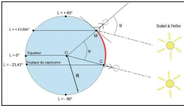
**Fig. 2a.** Mesure du diamètre de la Terre avec la méthode d'Ératosthène, dans le cas particulier du solstice d'hiver.
