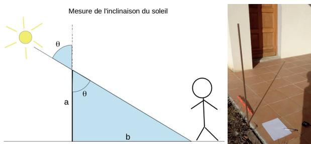
Fig.1. Mesure de l'angle  $\theta$ , distance zénithale du Soleil au solstice d'hiver, lors de son passage au méridien à partir de l'ombre d'un piquet vertical.
