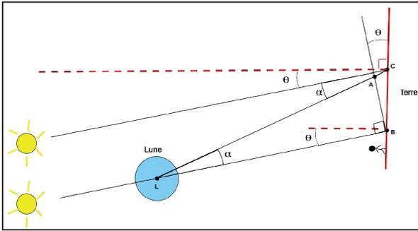
**Fig. 4.** Détermination de la distance Terre Lune à partir d'observations à Villariès (point C) de l'éclipse du 03/10/2005, qui était annulaire à Alger (point B). Pour simplifier, on considère la Terre plate entre Villariès et Alger.
