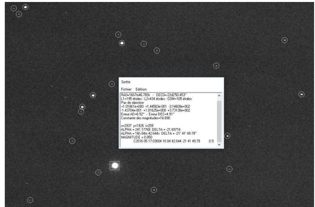
**Fig.3.** Copie d'écran d'IRIS avec le résultat de la réduction pour le 17 mai 2016. Sur la photo les étoiles reconnues ont été automatiquement entourées par IRIS. Dans la fenêtre des résultats : coordonnées du centre du champ (fournies par l'utilisateur) puis résultats des calculs effectués par le logiciel (lignes 1 à 7). Une fois la réduction effectuée, il suffit d'encadrer un objet sur l'écran (ici Mars) pour obtenir ses coordonnées.
