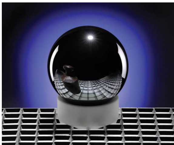
Fig.4. Sphère de silicium 28 dans laquelle se reflète un vieil étalon du kg. C'est une telle sphère qui permet de réaliser une mesure précise du nombre d'Avogadro. Son écart à la forme sphérique parfaite correspondrait à l'échelle du globe terrestre à une variation d'altitude d'environ 2 m.
