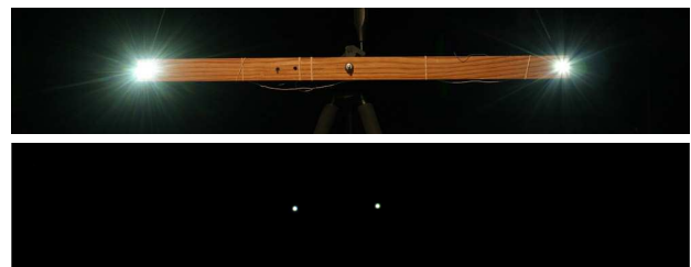
Fig.7a. Deux DEL (ou LED en anglais) espacées de 87,3 cm. b. Ces deux DEL photographiées à 100 m avec l'objectif de 300 mm de focale, le même que celui utilisé pour la photo de la figure 6.
