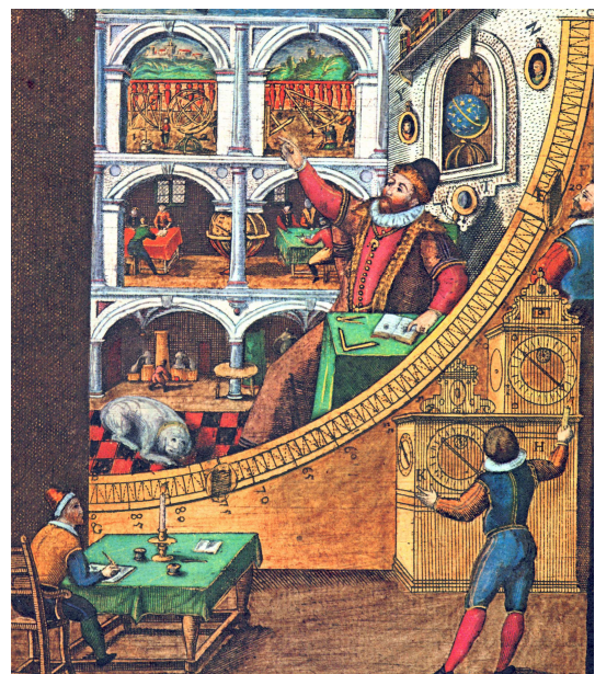
Fig.4. Cadran mural de Tycho Brahe. Avec ces grands instruments sans optique, la précision est de l'ordre de la minute d'arc.
