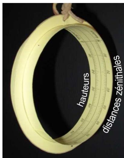
Fig.7. L'anneau, ses graduations et sa couronne circulaire de mise en forme.
