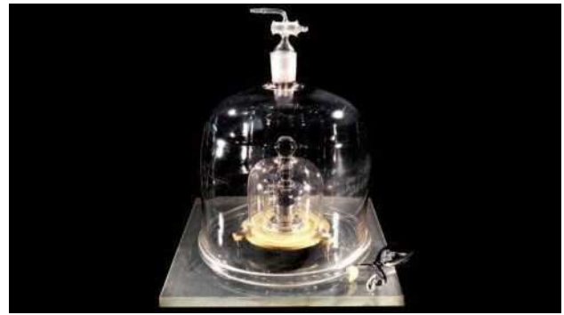
Fig.2. Photo d'une des copies du prototype international du kilogramme, déposé au BIPM.
