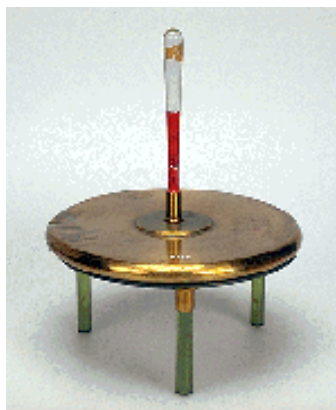
Fig.3. L'électrophore, longtemps la seule source électrique.
