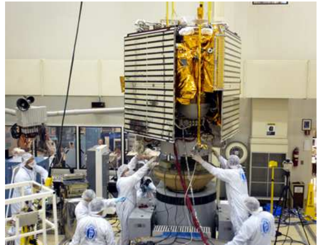
Fig.2. La sonde Messenger en cours de tests de tenue aux vibrations importantes que génère la séquence de lancement.
