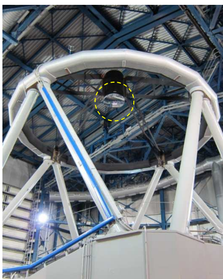
Miroir secondaire (1,20m de diamètre), dans le cercle.
