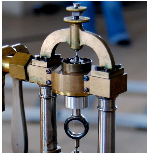
*Fig.2. Miroir tournant de l'expérience de 1862 (Observatoire de Paris). On notera les 16 pales de la turbine redessinée, ainsi que le cylindre d'aluminium entourant les trois vis d'ajustage du compensateur d'inertie visibles sur le modèle de 1850 (fig. 1). Le miroir a perdu son argenture.*
