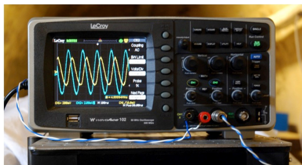
Fig.2. Traces des signaux des deux trajets court et long. Un ajustement de la fréquence du laser modulé permet de chercher la superposition des deux courbes.
