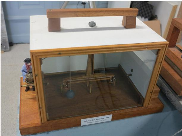
**Fig.5.** La balance de Cavendish et la maquette de la balance historique réalisées toutes deux par Georges Paturel
