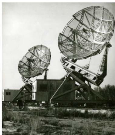
Fig.5. Les deux antennes de l'interféromètre à base variable de Nançay. Ce sont des antennes de radar Würzburg placées sur une monture équatoriale, dont l'axe de rotation est parallèle à celui de la Terre, ce qui permet de suivre le mouvement diurne des sources avec un seul mouvement lent.
