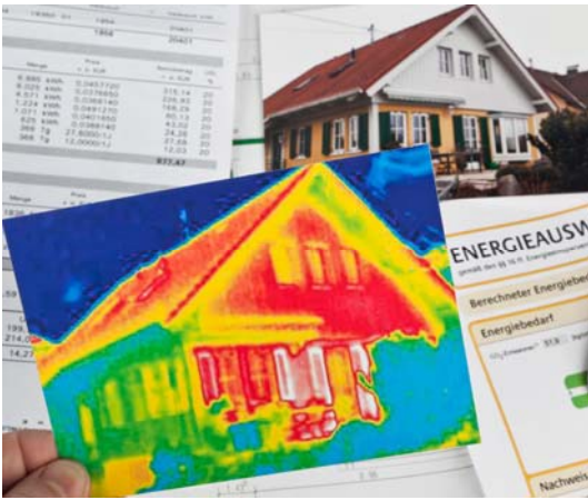
Doc.9. Image d'une habitation en infra rouge. Tout corps émet des ondes électromagnétiques en fonction de sa température. Pour des températures comme celles rencontrées sur Terre, comprises entre -50 et +50 °C, l'émission a lieu principalement dans l'infrarouge. Un capteur sensible à ce rayonnement peut ainsi mesurer la température, ce qui permet de connaître les déperditions énergétiques. (image 123RF/ginasanders).
