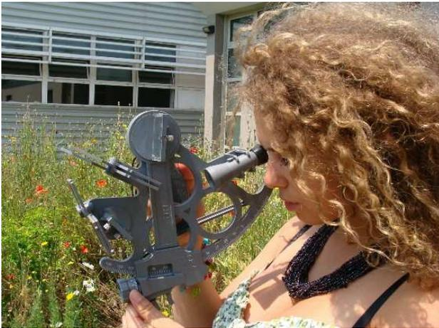
**Fig.2.** Les différentes parties d'un sextant. Le petit miroir (semi réfléchissant), la lunette et le limbe sont fixes. Le grand miroir est mobile et se déplace avec l'alidade. Les filtres colorés permettent d'observer le Soleil sans danger.
