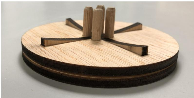
**FIG. 5** – Le pied une fois assemblé. Pour y installer la sphère armillaire, il faut insérer entre les tourillons le premier vertical et le méridien, qui doivent reposer sur les pièces concaves. Vérifier que la sphère céleste tourne sans frottement.
