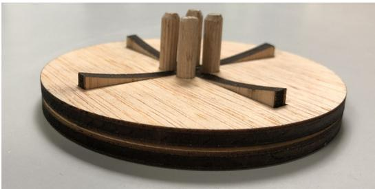
**FIG. 9** – Le pied une fois assemblé. Pour y installer la sphère armillaire, il faut insérer entre les tourillons le premier vertical et le méridien, qui doivent reposer sur les pièces concaves. Vérifier que la sphère céleste tourne sans frottement.
