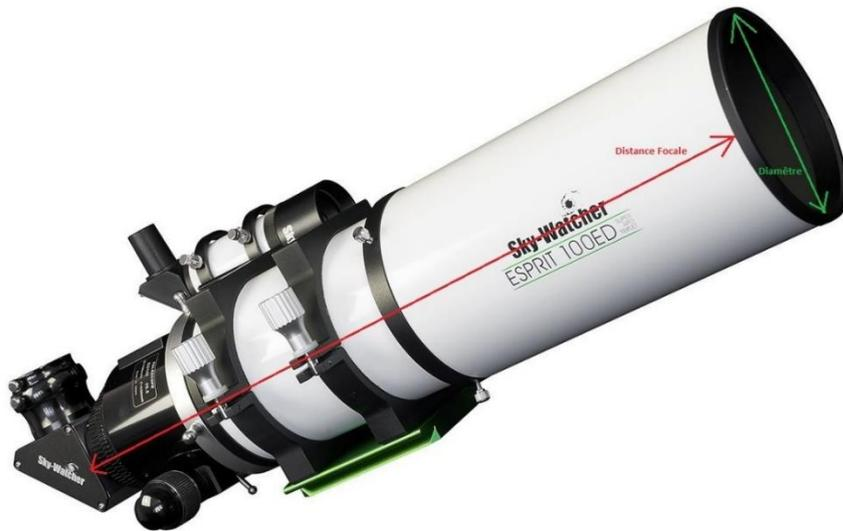
Le rapport (distance focale) /diamètre détermine l' « ouverture ». Ces 2 paramètres sont très importants, car ils vont déterminer les objets à imager, mais aussi la luminosité (et donc les temps de poses des photos).
