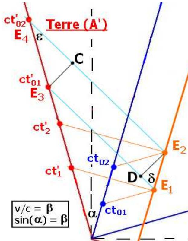
Pour retrouver la relation entre  $\Delta T'_0$  et  $\Delta T_0$  on exprime les deux segments égaux  $E_2D$  et  $E_3C$  en fonction, respectivement, des segments  $E_1E_2$  (égal à  $c \cdot \Delta T_0$ ) et  $E_3E_4$  (égal à  $c \cdot \Delta T_0$ ) et des angles  $\delta$  et  $\epsilon$ .
