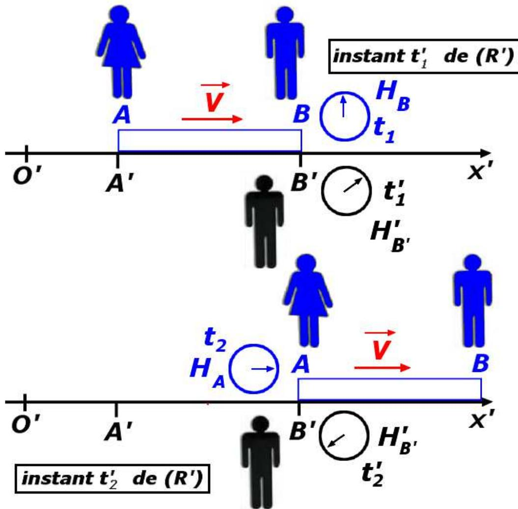
Dans le référentiel  $(\mathbf{R}')$ , un observateur placé en  $B'$  voit passer tout d'abord l'extrémité  $B$  de la règle à l'instant  $t'_1$  puis l'extrémité  $A$  à l'instant  $t'_2$ .  $\Delta t' = t'_2 - t'_1$  est un intervalle propre puisqu'il est mesuré par une seule horloge  $H'_B$  de  $(\mathbf{R}')$ . Durant  $\Delta t'$  la règle s'est déplacée de la distance  $L' = A'B'$  et nous avons donc  $\Delta t' = L'/V$ .
