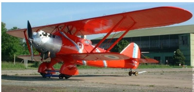
FIGURE C.2 – Le Bréguet 19 « Super Bidon » de Costes et Bellonte (1929), semi biplan, moteur Hispano Suiza 650 CV, vitesse max 250 km/h, masse en charge 6375 kg, plafond 6700 m, rayon d'action max 9000 km (oui, 9000 km !). Magnifique image pour susciter un désir d'aventure !
