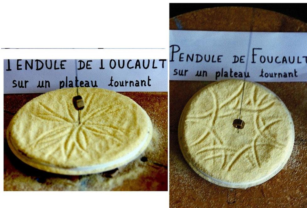
FIGURE 1.5 – Pendule de Foucault élémentaire monté sur un plateau tournant. Traces des trajectoires dans la semoule. À gauche : C.I. type « Copernic » ; à droite : C.I. type « Terre ». Les irrégularités sont dues aux à-coups du système d'entraînement bricolé sur place.
