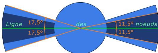
Fig.7. La pièce n° 5 en forme de papillon. La limite de  $11,5^\circ$  correspond à l'angle maximal entre la direction du Soleil et la ligne des nœuds pour une éclipse totale de Soleil (totale ou partielle pour la Lune) et celle de  $17,5^\circ$  à une éclipse partielle de Soleil (par la pénombre pour la Lune).
