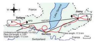
On ajuste les longueurs des fibres optiques de telle sorte que nos résultats des mesures obtenues soient bien synchrones. Et l'on s'est dit : si l'effet est vraiment immédiat on ne va rien voir mais si quelque chose porte l'information, si ce n'est pas de la télépathie, on va peut-être observer un certain délai. Ceux qui connaissent bien la théorie de la relativité vont se dire : on va aligner cela dans quel
