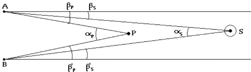
Ici la parallaxe du Soleil  $S$  est  $\alpha_s$  et la parallaxe de la planète  $P$  est  $\alpha_p$ . Les angles  $\beta_s, \beta_p, \beta'_s, \beta'_p$  sont les angles que forment respectivement les droites  $AS, AP, BS$  et  $BP$ , avec une direction arbitraire de référence, dirigée par exemple vers une étoile infiniment lointaine, mais hélas invisible à cause de l'éclat du Soleil...
