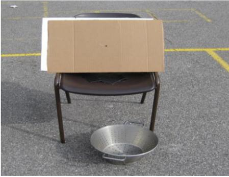
Un sténopé est un très petit trou percé dans un support qui crée par projection une image inversée d'une source lumineuse. Tout ustensile perforé peut réaliser un sténopé. Avec une source intense (Soleil), l'image créée est assez lumineuse pour être observée.
