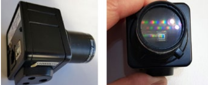
Fig.4. Le Star Analyzer fixé sur la caméra. Le réseau doit être aligné avec le capteur : en plaçant les traits du réseau parallèles à la largeur du capteur, le spectre se forme suivant la longueur.
