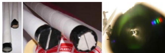
Fig.2. Spectroscopie maison et spectre d'un tube fluorescent.
