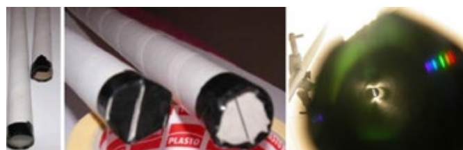
Fig.2. Spectroscopie maison et spectre d'un tube fluorescent.
