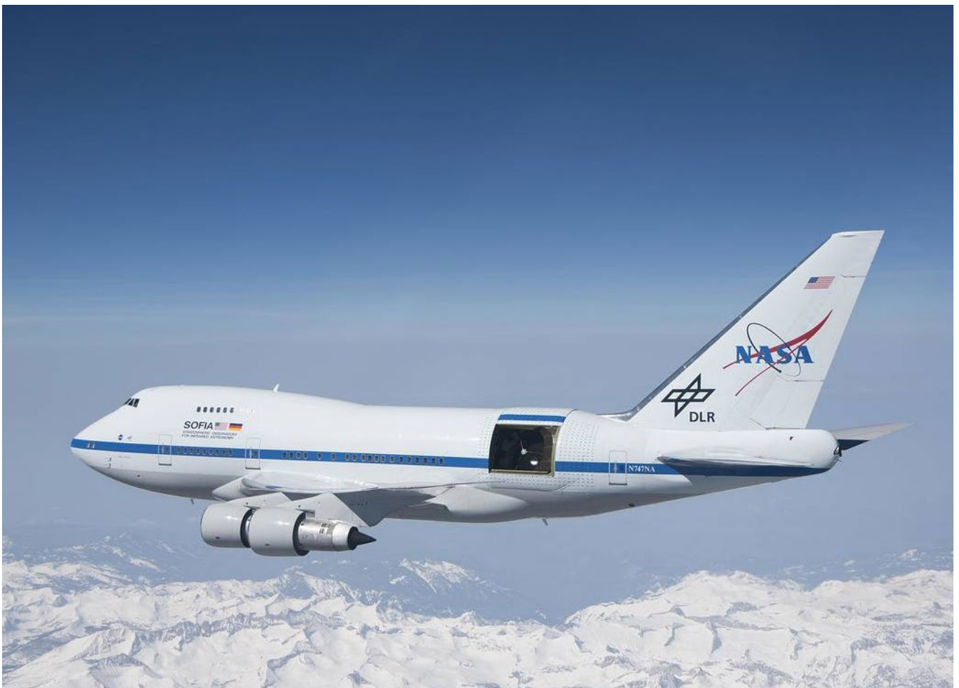
Image.5. Boing 747 Sofia avec la trappe du télescope ouverte (Nasa, DLR).
