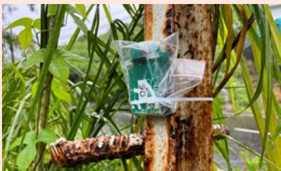
Enregistreur bioacoustique installé dans la commune de Saint-Joseph lors d'une expérimentation visant à étudier les effets de l'extinction de l'éclairage public sur l'utilisation des paysages par les chiroptères.
