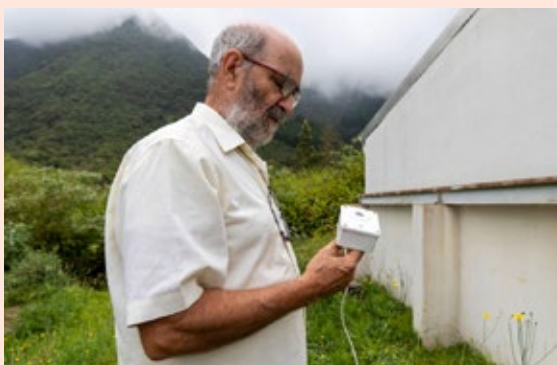
Installation d'un photomètre TESS-W à l'Observatoire astronomique des Makes dans le cadre du déploiement d'un réseau de capteurs pour le suivi long terme de la pression lumineuse sur l'île.
