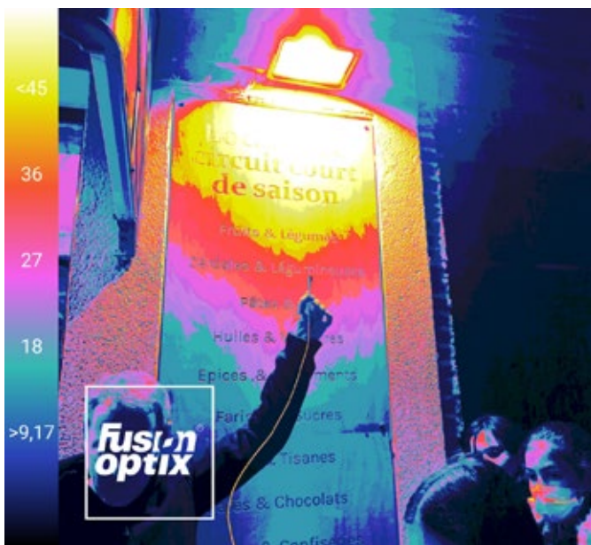
Fig.7. La mesure de l'éclairement faite en posant le luxmètre à même le trottoir a révélé une valeur de 350 lux ! La taille des élèves en avant plan donne une indication de la distance séparant le spot DEL du luxmètre. Cette valeur est à comparer à celle de 300 lux, qui assure un éclairage suffisant sur un poste de travail avec des tâches ne nécessitant pas de perception de détails 9 . Le professeur tient la fibre du spectrophotomètre, les élèves l'ordinateur portable.
