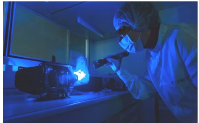
Image.4. Inspection sous UV de l'instrument PHEBUS pour la mission BEPI COLOMBO (Cnes).
