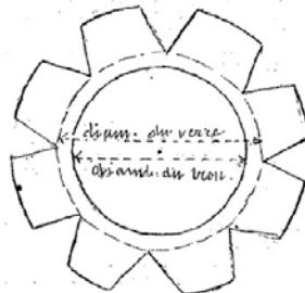
Fig. 9. — Rondelle pour l'objectif. (Grandeur naturelle.)
