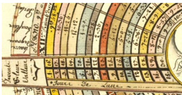
Fig.5. Zoom de la volvelle de la figure 4. Une alidade est graduée en jour de Lune de 1 à 15 puis de 16 à 30. Elle permet de donner la lecture directement entre le jour de Lune et l'heure de la marée haute une fois l'alidade placée sur le lieu choisi. Ici par exemple, la règlette est placée pour le Havre et on peut lire 9 h 48 min en face de 1 et 16 pour l'âge de la Lune (ligne jaune).
