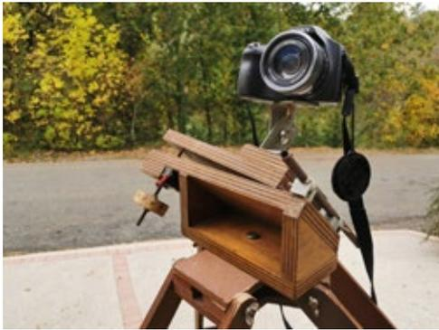
Cet « instrument d'un autre siècle » (le vingtième), reste d'actualité. Il fonctionne sans pile, sa mise en station (réglage de la charnière pour qu'elle vise soigneusement le pôle céleste) est aisé. Maintenant que les capteurs sont numériques, les sujets des
