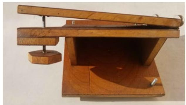
Un bricolage inventif permettant d'embarquer des objectifs photos jusqu'à 200 mm de focale et des pauses pouvant atteindre 10 min sans danger.
