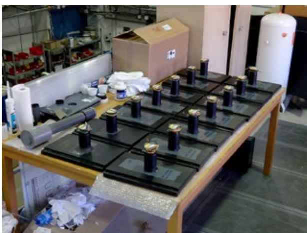
Fig.2. Détecteurs en cours de montage : ici on voit les photomultiplicateurs disposés sur les scintillateurs.
