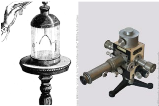
Fig. 1a. À gauche, schéma des premiers électroscopes à feuilles d'or, suspendues à une tige conductrice qui, une fois chargée par induction ou par contact, amène les feuilles à se repousser mutuellement.
