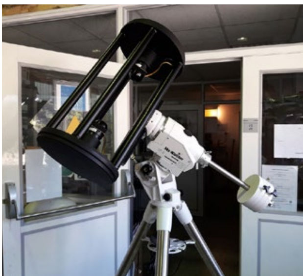
Fig.9. Le télescope à muons est constitué de 2 scintillateurs circulaires chacun équipés d'un photomultiplicateur (embouts ronds visibles sur la photo). Cet instrument est relié à un PC et détecte le passage de particules chargées (muons, électrons, particules alpha).
