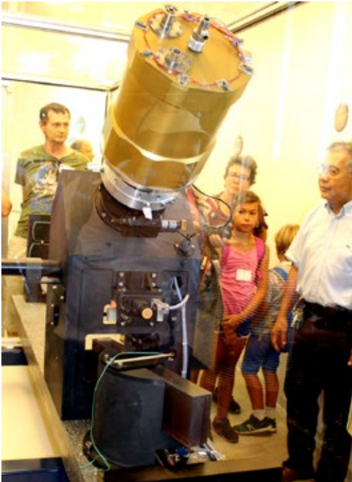
ÉLODIE, le spectroscopie qui a permis cette découverte à l'observatoire de Haute-Provence par la méthode des vitesses radiales
