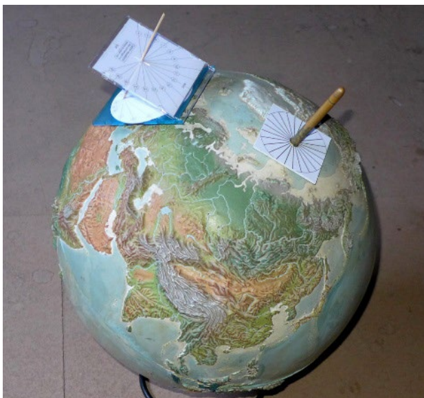
Fig.2. Cadrans équatoriaux installés au pôle Nord et en Europe.
