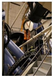
de 4 mètres), par un technicien suspendu dans une nacelle sous la coupole, et muni d'une lance à neige carbonique!
