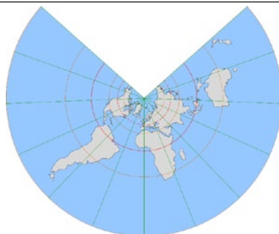
Fig.24a. Carte de la Terre en projection conique conforme jusqu'à la déclinaison de -60^\circ . Projection sur un cône tangent au parallèle +47^\circ (en rouge).
