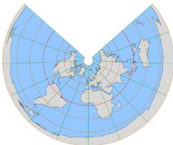
Fig.22a. Carte de la Terre en projection conique mérid-équidistante. Projection sur un cône tangent au parallèle +47^\circ , indiqué en pointillés rouges (latitude moyenne en France métropolitaine).
